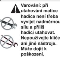
**Varování: při utahování matice hadice není třeba vyvíjet nadměrnou sílu a přilížit hadici utahovat. Nepoužívejte klíče ani jiné nástroje. Může dojít k poškození.**
