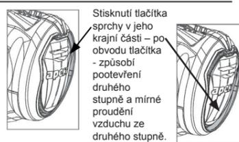
Stisknutí tlačítka sprchy v jeho krajní části – po obvodu tlačítka - způsobí pootočení druhého stupně a mírné proudění vzduchu ze druhého stupně.
