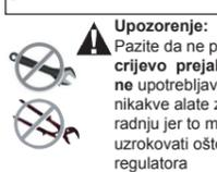
**Upozorenje:** Pazite da ne pričvrstite crijevo prejak i ne upotrebljavajte nikakve alate za ovu radnju jer to može uzrokovati oštećenje regulatora
