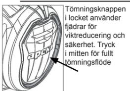
Tömningsknappen i locket använder fjädrar för viktreducering och säkerhet. Tryck i mitten för fullt tömningsflöde
